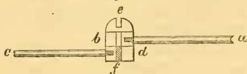
bildeten, wurden nach Fig. 2 durch Schrauben *ef* fest vereinigt, welche durch kleine an den Enden der Dräthe *a* und *c* befindliche
